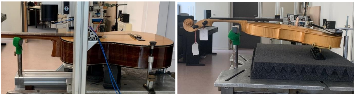
Abbildung 1 - Bestehender Labormessaufbau für Konduktanzmessung mit optimierten Lagerungsbedingungen
