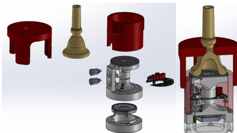
Abbildung 5 - Explosions- und Schnittzeichnung der analogen Version des Impedanzmesskopf-Funktionsmusters
