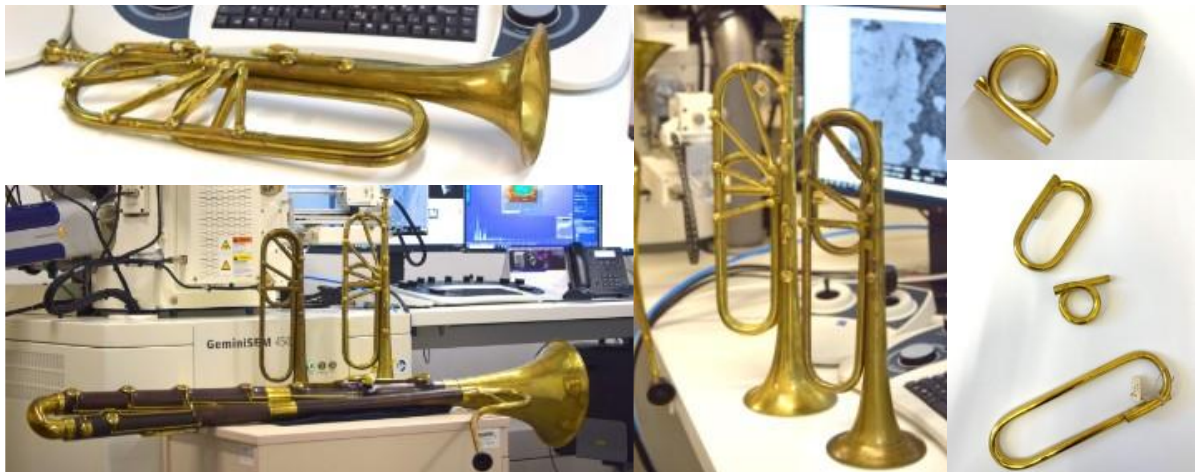
Abbildung 1: Analyse der chemischen Zusammensetzung verschiedener historischer Instrumente mittels EDS und WDS im REM: zwei Klappentrompeten und ein chromatisches Basshorn (19. Jhd.)
